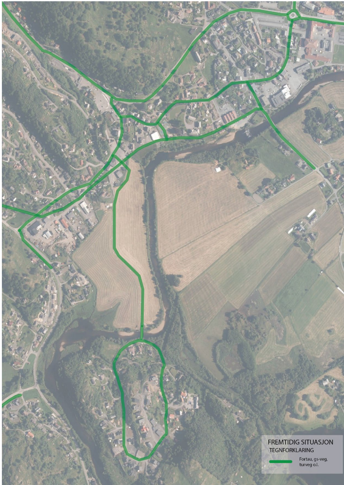
21 Her vises fremtidig situasjon for myke trafikanter. Årstadøyne er knyttet sammen med eksisterende tilrettelagte traséer for myke trafikanter gjennom etablering av turvei langs Øynoveien.
