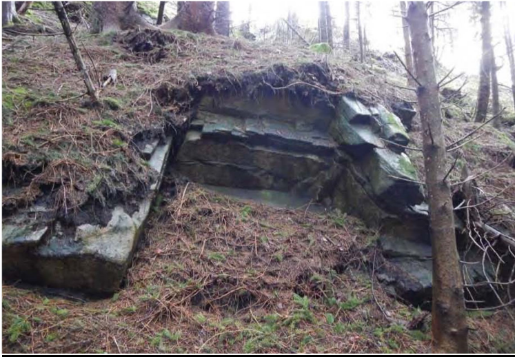
Figur 23: Område F. Løse blokker. Kilde: Multiconsult, rasvurderingsrapport
