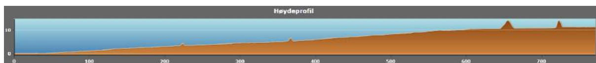
Figur 19. Høydeprofil for Avsnitt 1 fra sjø og opp til Nedra Hellvikvatnet. Lengde 770 m, gradient 1.5 % (hoydedata.no).
