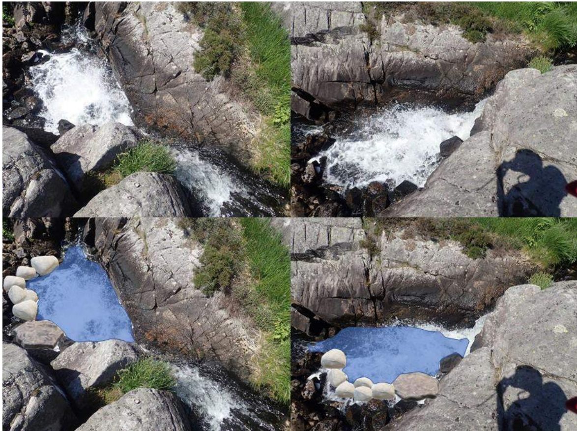
Figur 14. Prinsippskisse for å lette fiskevandring gjennom foss oppstrøms Stemmavatnet. Den store flate steinen vannstrømmen spyles mot i dag, samt at en del annen stein og blokk fra kulpen må forflyttes for å danne en dypere fossekulp. Disse steinene kan benyttes for å konsentrere vannstrømmen i ett løp ut av kulpen.
