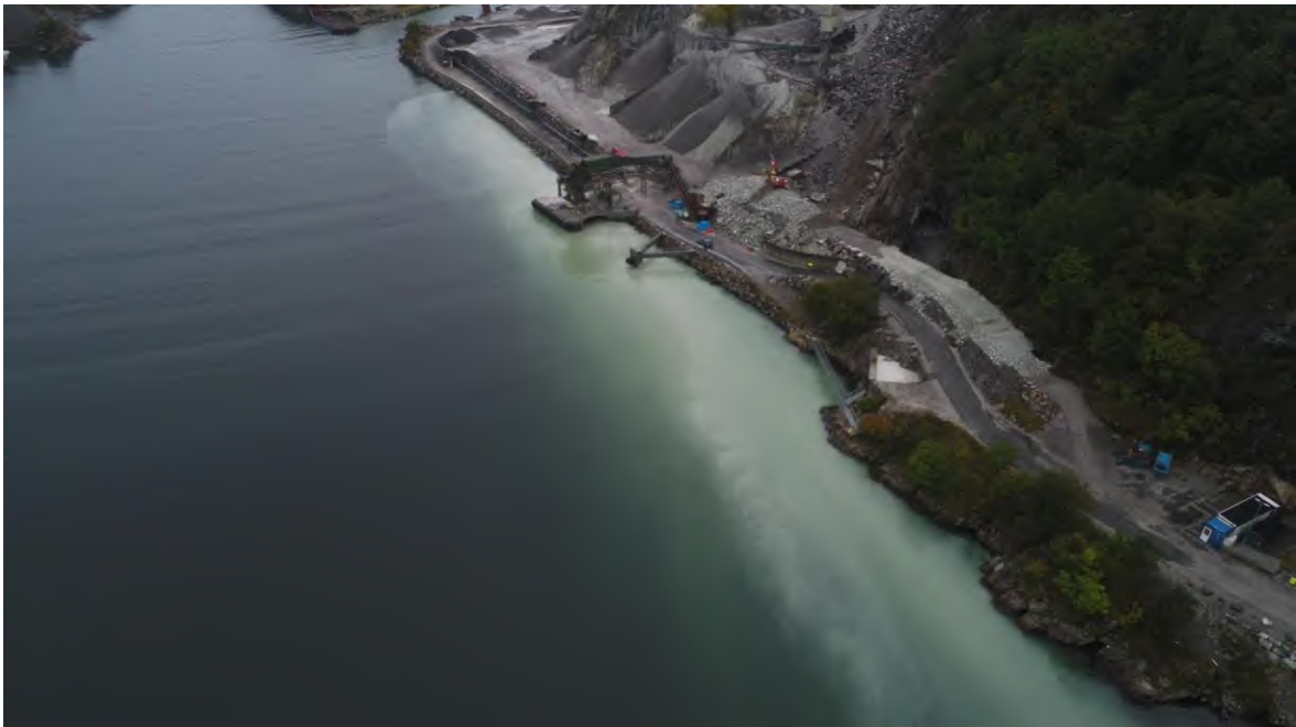
Figur 2. Dronebilde som viser partikkelplumen etter en nedbørsepisode i Rekefjorden, september 2022 (foto, Rekefjord Stone).
